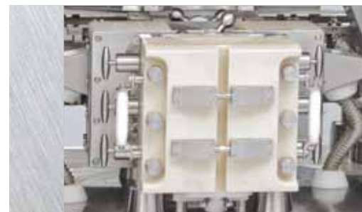
Rotierendes Kammersystem zur kontinuierlichen Fleischbeschickung.
