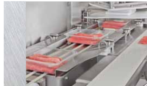
Abtransport befüllter Schalen und separate Reststück-Austragung.
