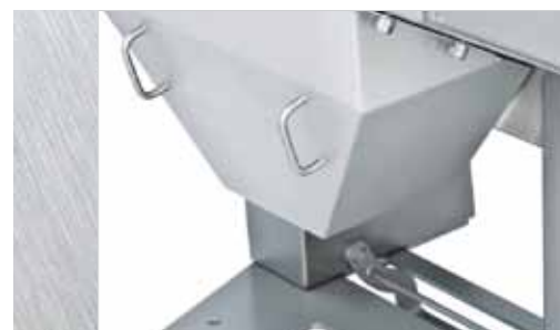
EVM 4004: Отводная шахта для пленки предотвращает падение остатков пленки мимо сборного ящика.
