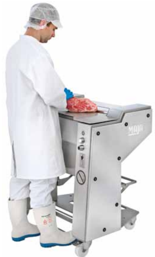
С EVM 4006 возможно эргономичное снятие плёнки даже с больших кусков мяса.
