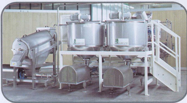
In alto a sinistra: Vasche di canditura per castagne con concentratore e serbatoio di stoccaggio sciroppo. / Top left: Chestnut candying tanks with concentrator and syrup storage tank.
