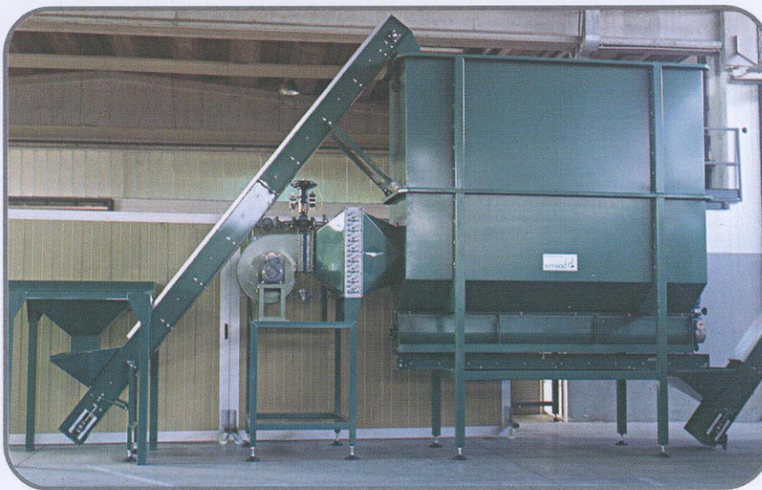
Essiccatoio continuo per castagne con elevatore di carico. Continuous chestnut drier with loading elevator.
