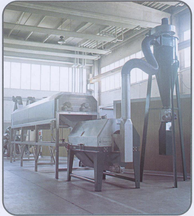
Linea completa per la produzione in continuo di castagne arrostate con o senza buccia. / Complete line for the continuous production of roast chestnuts, with or without skins.
