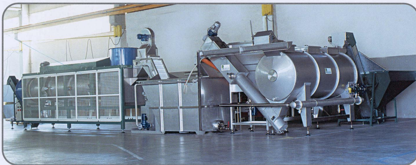
Linea di sterilizzazione continua completa di schiumatore automatico ed asciugatore a tamburo. Continuous sterilization line with automatic skimmer and drum drier.
