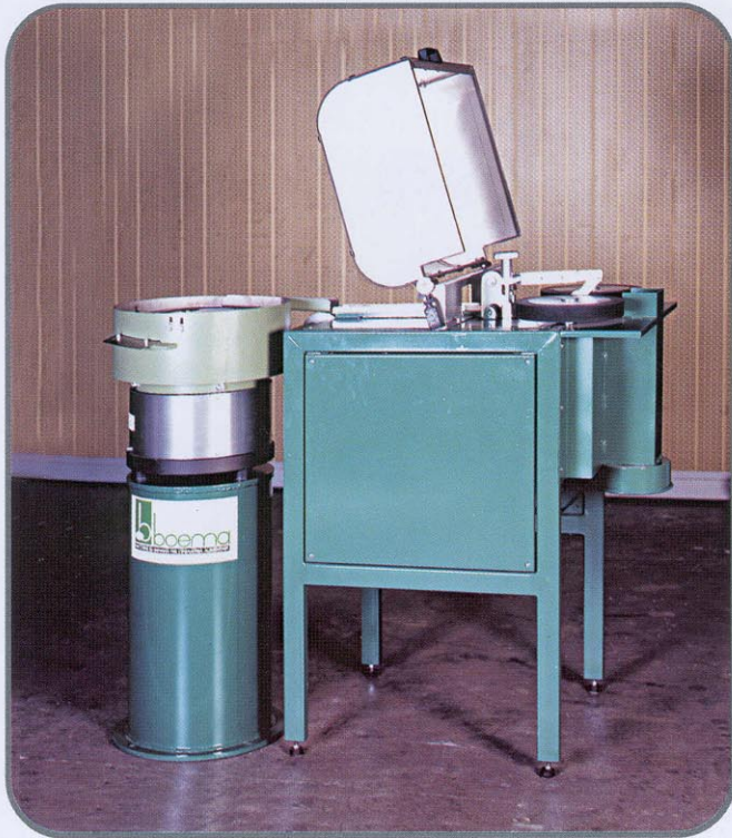
Inciditrice per castagne destinate alla produzione di caldarroste. Scorer for roast chestnut production.
