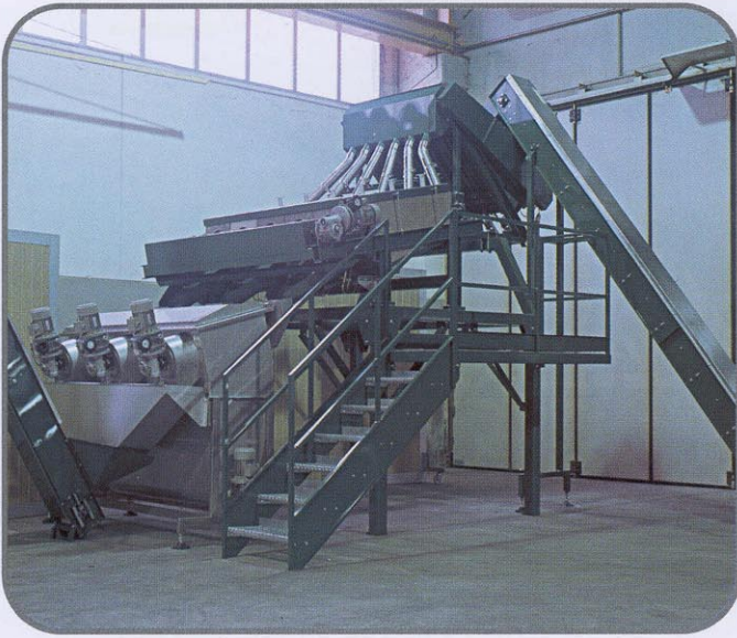
Linea di pelatura "brulage" a 6 forni completa di elevatore di carico e n° 3 pulitrici tangenziali. / 6-oven "brulage" peeling line with loading elevator and 3 tangential cleaners.
