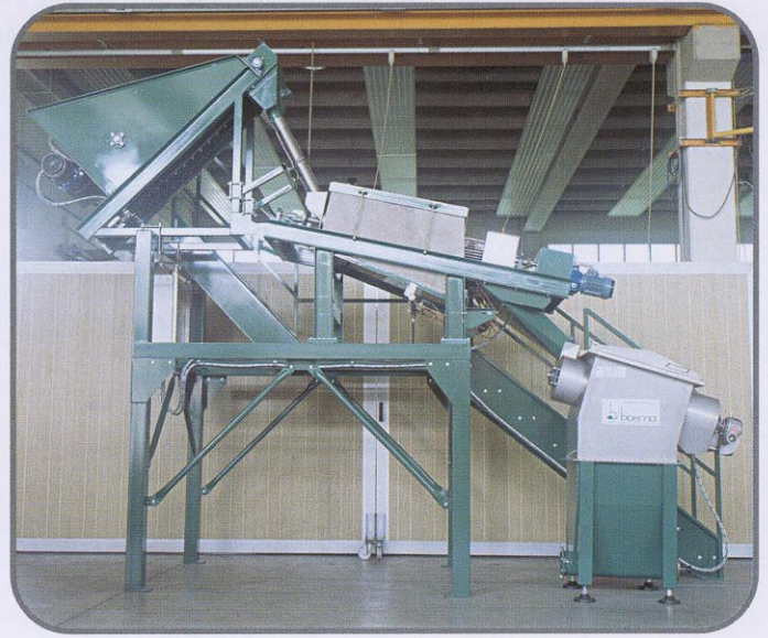
Impianto pilota per la pelatura "brulage" composto da dosatore a catene, n° 2 forni e n° 1 pulitrice tangenziale. / Pilot "brulage" peeling plant comprising chain batcher, 2 ovens and 1 tangential cleaner.
