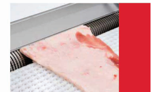
Опция: полностью автоматическое снятие шкуры со спинного шпига при помощи встроенной шкуросъемки, типа ВХА 434 NF
