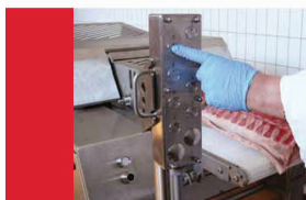
Стандартная версия работы с оборудованием типа BXM LOIN: ручная регулировка толщины шпига при помощи кнопки. Для обработки более чем 200 спинных частей в час.
